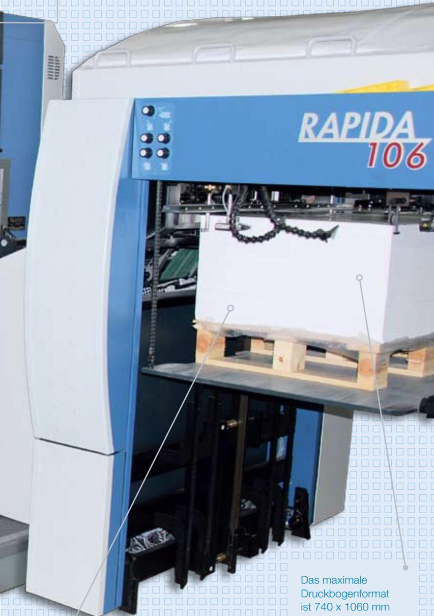
Das maximale Druckbogenformat ist 740 x 1060 mm (darum Rapida 106). Maximale Papierstärke: 0,7 mm
